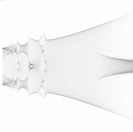
Abbildung 3: Antwort des nichtlinearen Duffing-Oszillators ( \alpha = 1 , \beta = 2 , \gamma = 2 und \delta = 0.1 ) Die Bildbreite umfasst 0 \leq \omega \leq 3 , die Höhe -3 \leq y \leq 3 .
