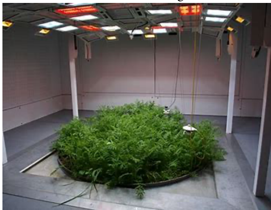
Écotron : chambre close dans laquelle peuvent être contrôlés durant plusieurs mois la température, la luminosité (intensité, durée et spectre), l'hygrométrie et les teneurs en N 2 , O 2 , CO 2 , N 2 , O 3 etc ... afin d'étudier par exemple les effets du réchauffement climatique sur les végétaux.
