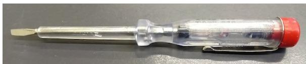
Abbildung 2: (oben) Der Phasenprüfer ist ein Schraubenzieher mit eingebauter Glimmlampe und hohem Schutzwiderstand.
