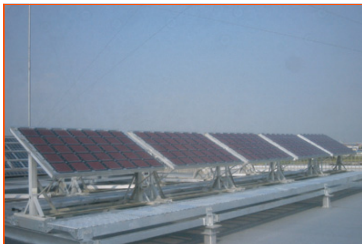
Figure 6 - De grands modules de cellules photovoltaïques à colorant produits par la société Aisin-Seiki-Toyota sont soumis à des tests à l'extérieur pour évaluer leurs performances et leur durabilité dans les conditions climatiques réelles régnant au Japon.
